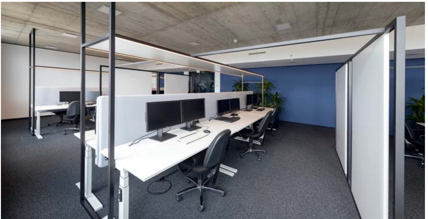
▲ Im Großraumbüro vereinen die Innenarchitekten mit einer Rahmenkonstruktion Licht und Akustik zur ästhetischen und funktionellen Einheit.
